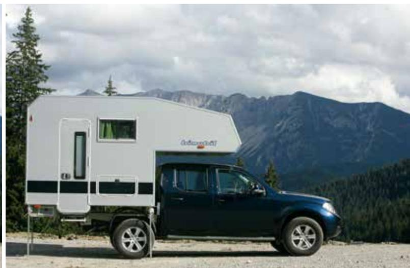
Trotz unseres Konstruktionsprinzips, die Wohnkabine direkt auf dem Fahrgestell aufzusetzen, kann die Pritsche des Originalfahrzeugs alternativ zur Wohnkabine weiter benutzt werden. Mit der zur Wechsellpritsche umgerüsteten Originalpritsche wird im Handumdrehen aus dem Fahrgestell wieder ein vollwertiger Pritschenwagen.
